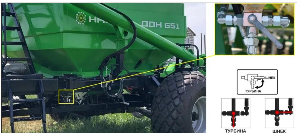
Рисунок 6 – Распределительный кран на бункере
