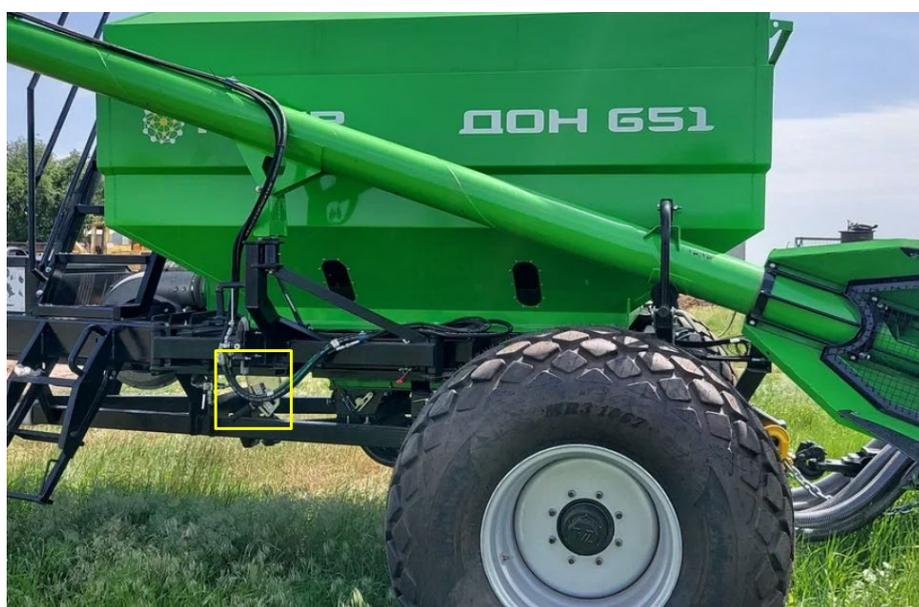
Рисунок 19 – Расположение рычага заслонки
