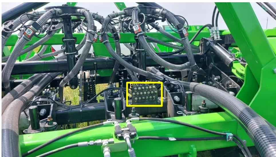
Рисунок 45 – Панель централизованной системы смазки
