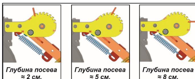
Рисунок 28 – Эксцентриковый упор
