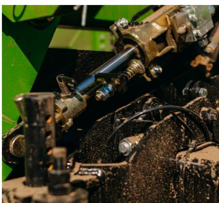
Рисунок 37 – Гидроцилиндр
