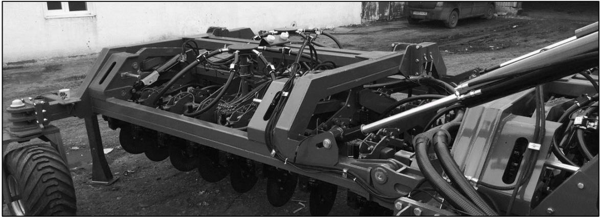
Рисунок 50 – Гидроцилиндры складывания боковых секций
