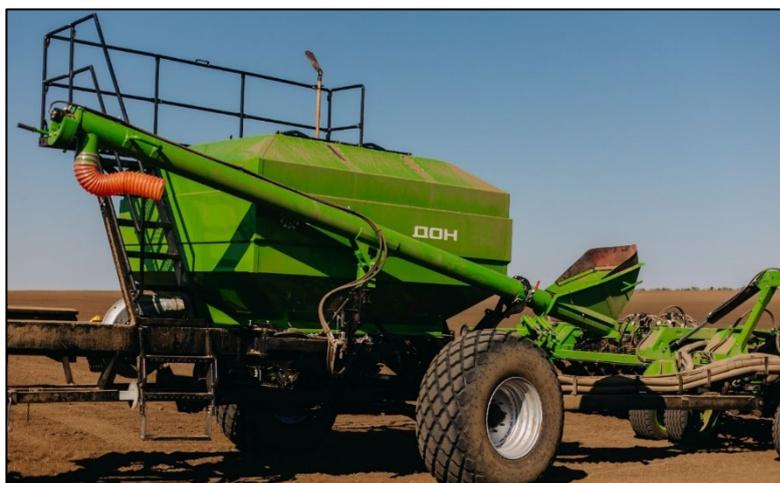
Рисунок 3 – Шнек в транспортном положении
